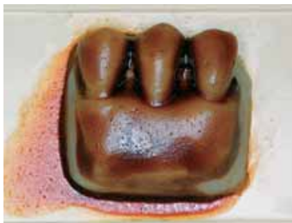
Abb. 2: Zahnsegment vor einem Putztest. Gleichmäßig verteilte künstliche Plaque.
