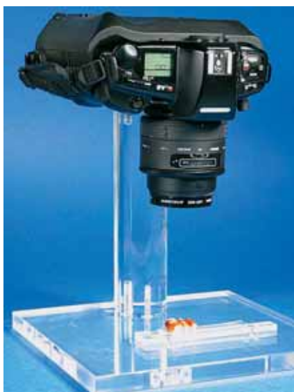
Abb. 4: Digitale Photo-Analyse. Die künstlichen Zahnreihen werden eingespannt, um immer dieselbe Position zu erhalten.
