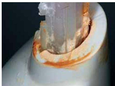
Abb. 14: Schmutznische zwischen Bürstenaufsatz und Gerät der Synchrosonic™. Diese Nische ist kaum zu reinigen.
