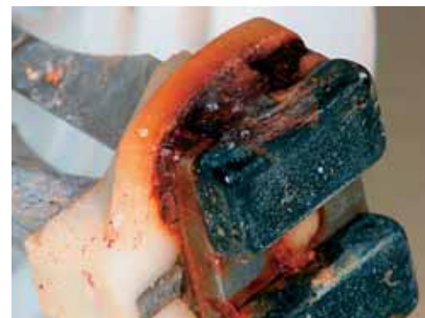
Abb. 8: Magnetsystem der Sonicare™ nach vier Wochen Nutzung. Starke Verschmutzung und Korrosion sind erkennbar.
