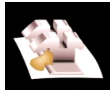
Abb. 11: Mäßige Verschmutzung bei dem Indexwert 3.
