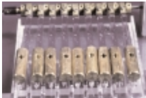
Abb. 5: Eigenkonstruktion einer Zahnputzmaschine. Ein Motor treibt über einen Exzenter gleichzeitig neun Zahnbürsten an.
